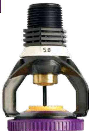
**BOCAL DE CONTROLE DE FLUXO.** O bocal de controle de fluxo (disponível apenas para a Série 3000) não apenas elimina a necessidade de reguladores de pressão, como também deixa passar os detritos com mais facilidade. Não deve ser usado em conjuntos de pendural de mangueira flexível.
