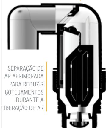
SEPARAÇÃO DE AR APRIMORADA PARA REDUZIR GOTEJAMENTOS DURANTE A LIBERAÇÃO DE AR
