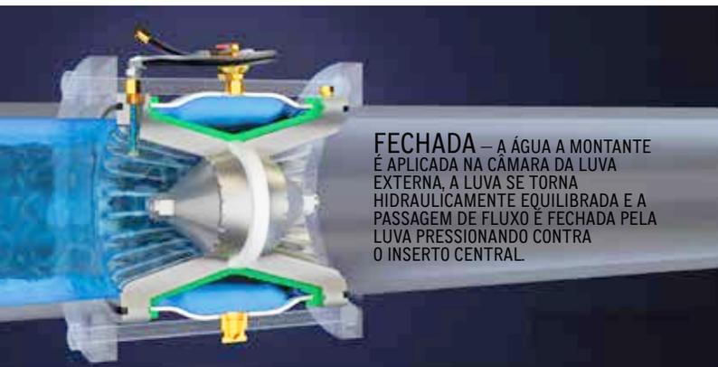
**FECHADA** — A ÁGUA A MONTANTE É APLICADA NA CÂMARA DA LUIVA EXTERNA, A LUIVA SE TORNA HIDRAULICAMENTE EQUILIBRADA E A PASSAGEM DE FLUXO É FECHADA PELA LUIVA PRESSIONANDO CONTRA O INSERTO CENTRAL.
